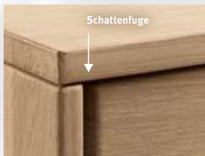
Kranzprofil 15 mm / gefalzte Seitenwange D 25 mm, Radius 3 Durch die Falz mit 15 mm sichtbarer Seitenwange und 10 mm Schattenfuge
